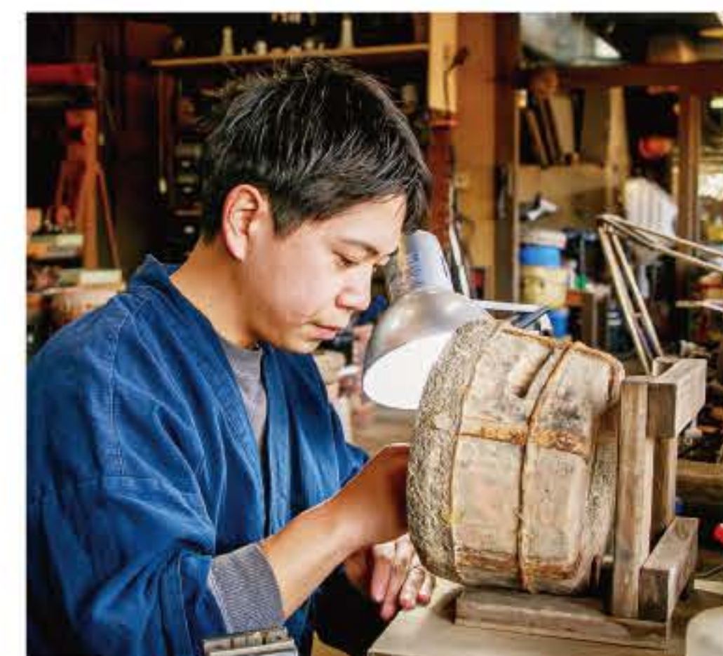
施文(せもん)作業。外型に一粒一粒霰の文様を描く。鑄型を作るだけで2か月以上かかる。
