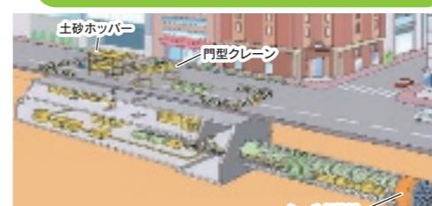
シールド機械で地盤を掘り進み、その後でコンクリート製や鋼製のブロックを円形に組み立てながら、トンネルをつくる工法
