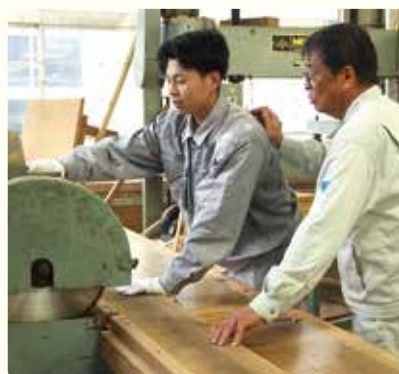
横切り丸のこ盤で木材を一定の長さに加工。
