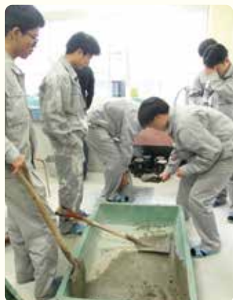
コンクリートを練り、円錐形の器具へ流し込む。
