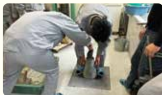
円錐形の器具を外し柔らかさを確認。
